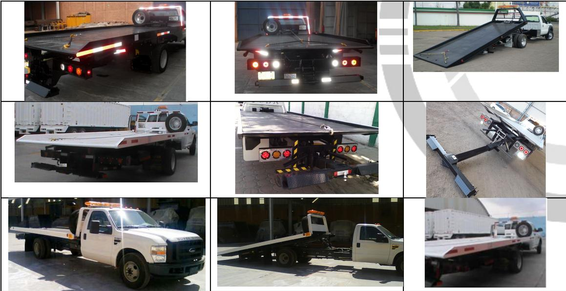
**GRÚA DE PLATAFORMA HIDRÁULICA (ESTILO PLANCHA) DE 23 PIES DE LARGO FABRICADA EN ACERO AL CARBÓN PARA TRASLADO Y ARRASTRE DE VEHICULOS MARCA REGISTRADA.**
