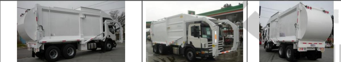
**CAMIÓN DE CARGA FRONTAL DE 20 YDS3 DE CAPACIDAD INSTALADO EN HINO SERIE 500 Y/ O INTERNATIONAL O CHASIS DE SU PREFERENCIA.**
